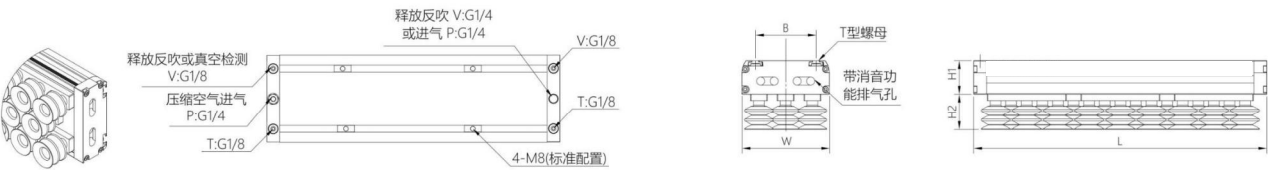
GP60 标准吸盘吸具（内置真空发生器）吸盘设计类型：PX03
